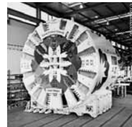
Großprojekt unter der Stadt: Der Erddruckschild S-497 (ø 8,70 m) ist eine von drei Herrenknecht-Tunnelbohrmaschinen, die für das Abwassersystem „Emisor Oriente“ in Mexiko-Stadt zum Einsatz kommen.
