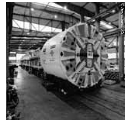
Metroausbau in Sao Paulo: Der Herrenknecht-EPB-Schild (ø 9,46 m) war für den Ausbau der Metro-Linie 4 in Sao Paulo im Einsatz.
