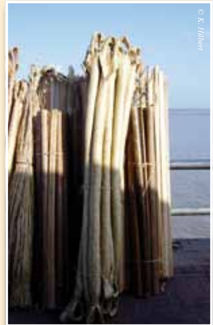
„Tipiti“: Die Teleskopresse wird aus engmaschig verflochtenen und flexiblen Palmfasern gefertigt
